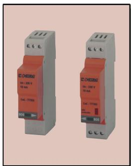
El Bloque Óptico de Señalización BOS 230 tiene como función el advertir, mediante teleindicación a distancia, del estado de servicio o de avería de los limitadores de tensión de las series PU, PM y PLT. La barrera constituida por un haz de luz luminoso permite el control de hasta 15 módulos de protección. En el caso de producirse un fallo, es accionado un contacto conmutado, que permite activar a distancia un equipo de alarma.
