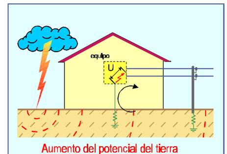
Cuando un rayo cae directamente al suelo o a través de una estructura conectada a tierra (puede ser un poste eléctrico, un pararrayos, etc.) la corriente de la descarga del rayo puede elevar el potencial del suelo varios miles de Voltios como consecuencia de la corriente que circula por el terreno.
